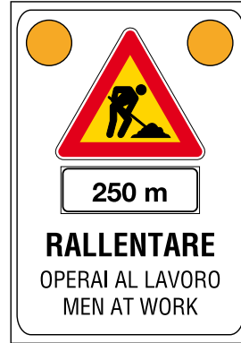
FIG. 5: cartello di preavviso con lampeggiatori a led Ø 200 mm alta efficienza. Dimensioni 135x200 cm. Posizionamento sul margine destro su cavalletto a circa 3.000 m dal triangolo “lavori in corso”
