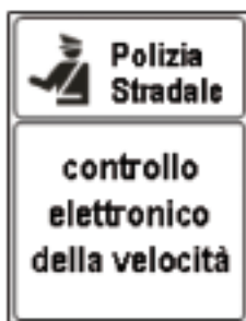
FIG. 19: cartello di preavviso 90x135 da posizionare su cavalletto in anticipo rispetto alla posizione del box autovelox mobile
