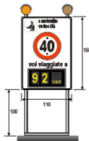
FIG. 20: dissuasore su cavalletto con rivelatore radar di velocità
