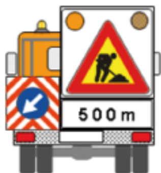
FIG. 14 esempi di: presegnalazione di cantiere mobile in corsia di emergenza; il pannello segnaletico con appendice distanziometrica deve in ogni caso contenere un triangolo “lavori in corso” con lato 120 cm e, nel caso dell’autocarro, essere integrato con lampeggiatori a led diam. 200 mm ad elevata efficienza.
