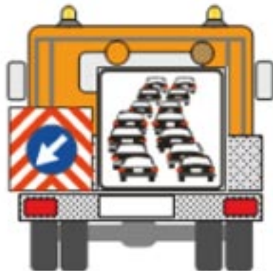
FIG. 7: esempio di cartello e autocarro utilizzabili per la presegnalazione di code o rallentamenti (in alternativa al mezzo dotato di PMV full color). Il pannello “code” deve avere dimensioni non inferiori a 90x90 cm. Il cartello Fig. II 398 Art. 38 (90x90) sul carrello, va obbligatoriamente applicato contestualmente al suo posizionamento.
