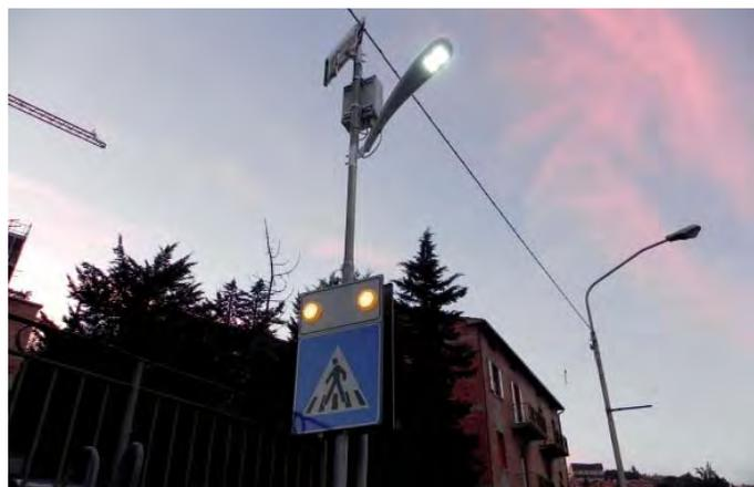
Passaggio pedonale a chiamata tramite **pulsante o rilevatore**. Il sistema è costituito da 2 lampioni a Led concentrati sui segni orizzontali zebra, segnali rafforzati da lampade diametro 100 mm. Il tutto alimentato tramite pannello fotovoltaico 20W (Art. 135 comma 3).
