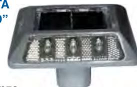
realizzato in alluminio e policarbonato ad alta resistenza, dimensioni 133x123x20 mm, perno metallico ht 55 mm Ø 40, peso: 600 gr, alimentazione: pannello solare e batteria ricaricabile, led: 6-8000 mcd Ø 8 mm, lampeggi 1/2 Hz, visibilità a 800 mt, sensore luminoso, IP68 resistenza alla compressione 1000 Kg/cm, resistenza al calore -35° +75°C BS873 DIN EN 1463-1
