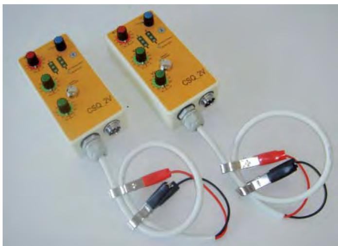
Le centraline elettroniche al quarzo CSQ\_2V permettono di gestire gli impianti semaforici da cantiere a 2 vie senza cavi di collegamento. L'utilizzo dei classici interruttori rotativi e di un sistema di controllo a microcontrollore consente di avere la massima semplicità di utilizzo senza compromettere affidabilità e funzionalità. Tramite la centralina è possibile far effettuare all'impianto 3 differenti funzioni:
