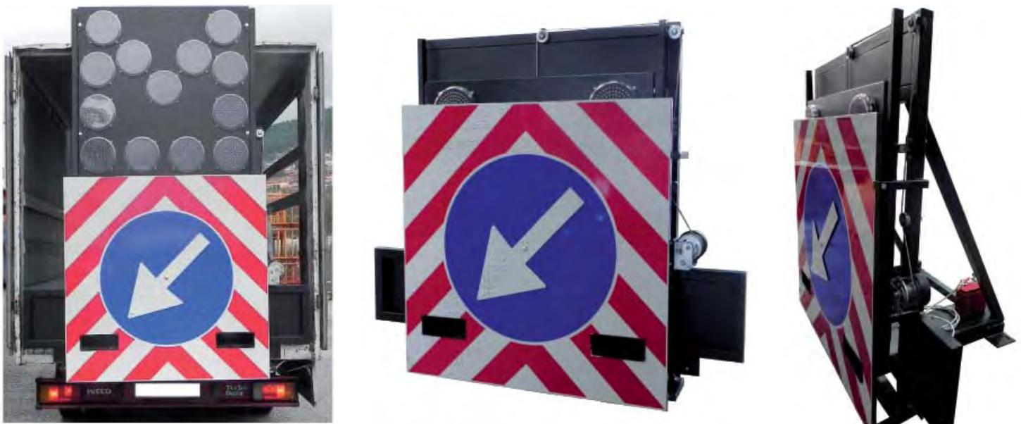
Struttura di impianto mobile Fig. 398, dimensioni 1350x1350 mm. integrato con pannello luminoso 13 lampade a scomparsa, sistema di segnalazione di deviazione e ostacolo da installare su autocarri e macchine operatrici.
